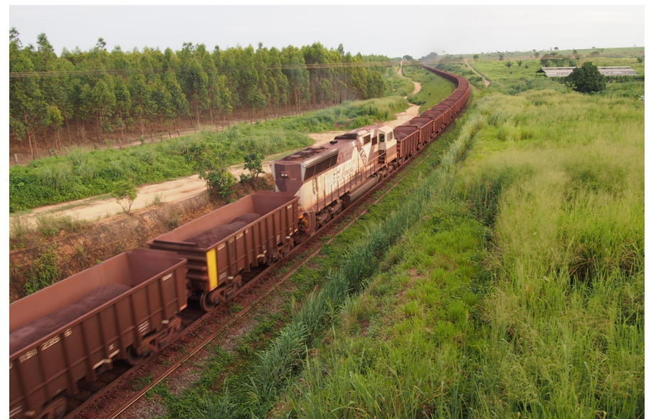
Der Beginn einer langen Reise: 3.5 Kilometer langer Zug (mit 5 Loks), im Norden Brasiliens, 1000 km unterwegs bis zum Hafen, von wo aus das Eisenerz per Schiff nach China, Deutschland, ... geht. Eine täglich stattfindendes "Berge Versetzen".
